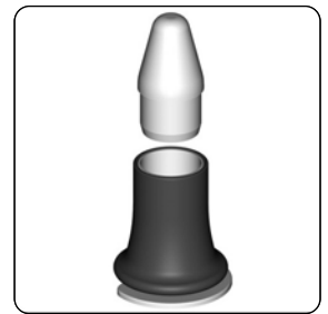
5. Breng de stralings-trechters aan op beide zijden m.b.v. het opschuifhulpstuk.
